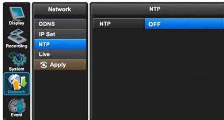
Режим NTP отключен по умолчанию. При включении данного режима вы можете указать настройки по умолчанию (time.bora.net) или самостоятельно установить домен и IP адрес, как показано на следующей диаграмме:
