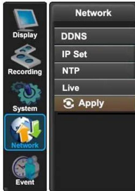
В разделе меню «Сетевые настройки» настраивается DDNS, IP адрес, NTP синхронизация, настройка параметров передачи видео.
